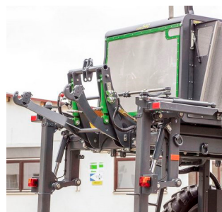
Abb. 4: Federung und Lenkung des Züm 540 Geräteträgers [8].
