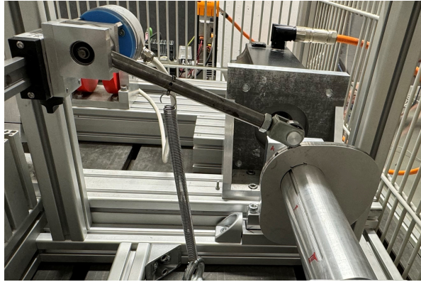
Abb. 5: Dreigliedriges Kurvengetriebe am Prüfstand
