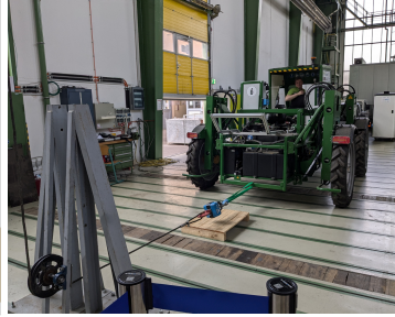
Abb. 11: Schleppversuch zur Bestimmung des Reibwertes.
