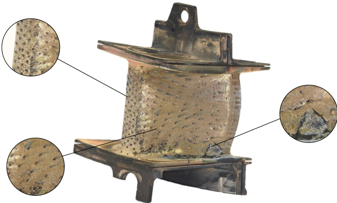
Abbildung 1.1: Aufnahme einer modernen filmgekühlten Hochdruckturbinenschaufel nach ihrem Einsatz in einem Flugtriebwerk
