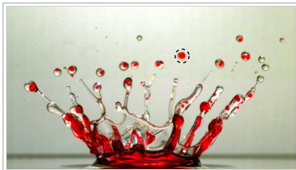
Abbildung 2.3: Tropfenaufprall auf Flüssigkeitsfilm mit unterschiedlichen, nicht mischbaren Fluiden [84]
